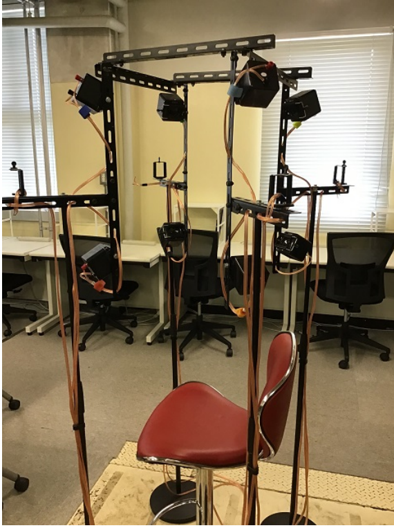
図5 定位実験におけるスピーカアレイ Fig. 5 Loudspeaker array in the localization test.
