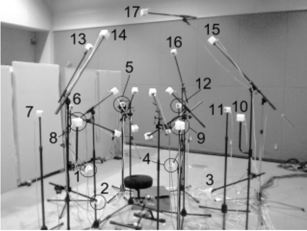
図 5 スピーカアレイと統制条件用スピーカ Fig. 5 Setup of the loudspeaker array and loudspeakers for control condition
