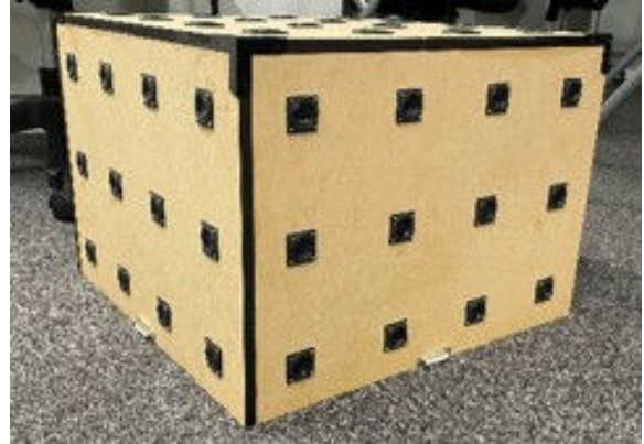
Fig. 1 放射型スピーカアレイの外観[3]
